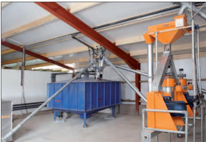
Doppelmühle in Kombination mit der Flüssigfütterung HYDROMIX
